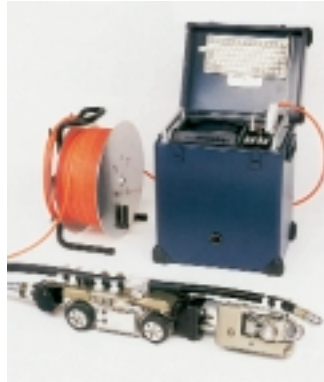
Tragbares Spülsystem, auf Roboter mit Kamera installiert
